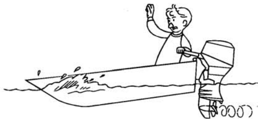
НЕПРАВИЛЬНЫЙ УГОЛ НАКЛОНА ВЫЗЫВАЕТ "ЗАРЫВАНИЕ" НОСА ЛОДКИ
